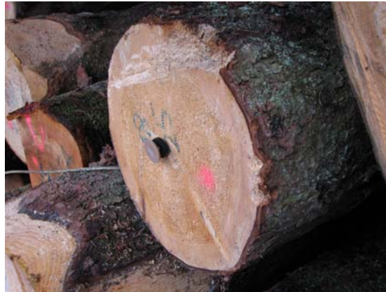
Abb. 1: Beispiel eines von der Forstlichen Versuchs- und Forschungsanstalt Baden-Württemberg und dem Ingenieurbüro Dr. Föllner & Partner zusammen entwickelten recyclefähigen Rundholz-Kennzeichnungssystems bestehend aus einem Ring-Transponder und dazugehörigem Nagel aus biologisch abbaubaren Material, der im Sägewerk abgesichert wird Bildquelle: FVA Baden-Württemberg
